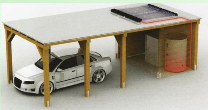
Die Dachfläche des Energie Carport wird mit „Weiser“ Kollektoren belegt. Die Größe des Wärmehamster ©(Speicher) wird auf den Energiebedarf des Gebäudes abgestimmt.
